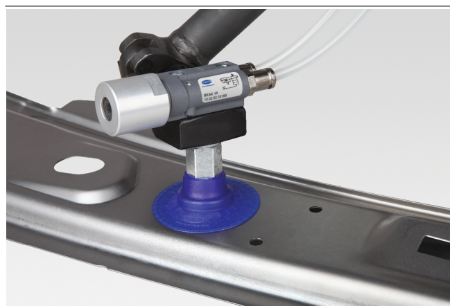
Децентрализованное создание вакуума эжектором SEAC непосредственно на присоске
